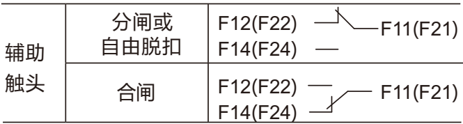
图6 辅助触头状态示意图
